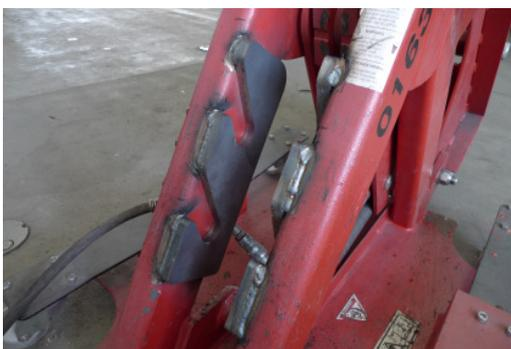
Montage durch Anschweißen der vier Befestigungsseisen und der beiden Zahnleisten für die Kettenverankerung.
